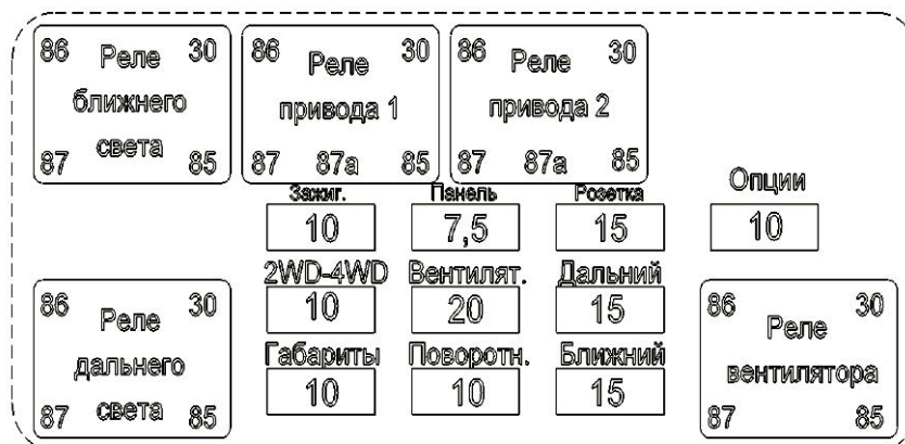
Рисунок 30 – Блок предохранителей и реле
